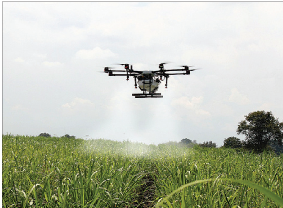
Dron na swój pokład może zabrać określoną dawkę nawozów i aplikować je precyzyjnie w oparciu o dokładne dane.
